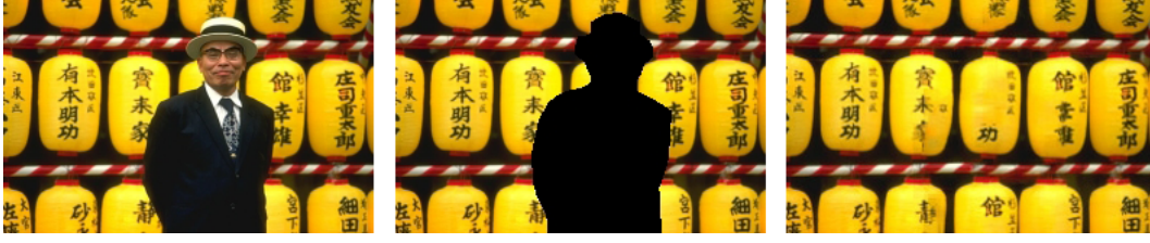
Figura 2.2: El problema de inpainting. De izquierda a derecha: Imagen original, Máscara de inpainting \Omega en negro y Resultado de inpainting de [31]
