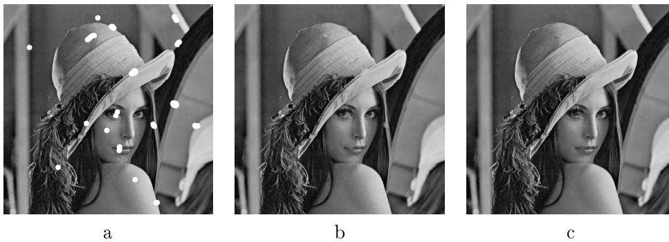
Figura 6.10: (a) Imagen original (483 x 405 píxeles, escala de grises), la máscara se seleccionó para eliminar las grietas que presenta la imagen (14258 píxeles). (b) Restauración mediante el algoritmo original de Bertalmío [6] (587,91 segundos). (c) Restauración utilizando la aproximación y el refinado (91,61 segundos).
