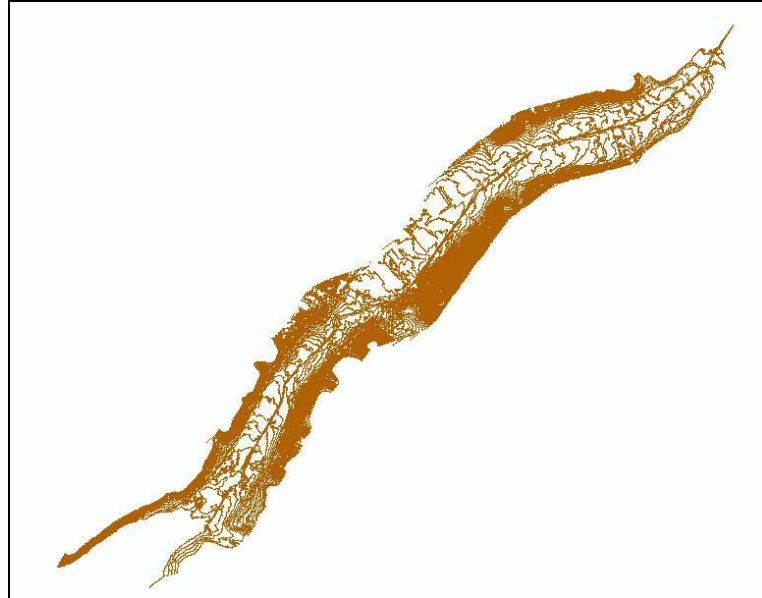
Figura 12. Curvas de nivel del MDT obtenido a partir de los datos LIDAR del cauce.
