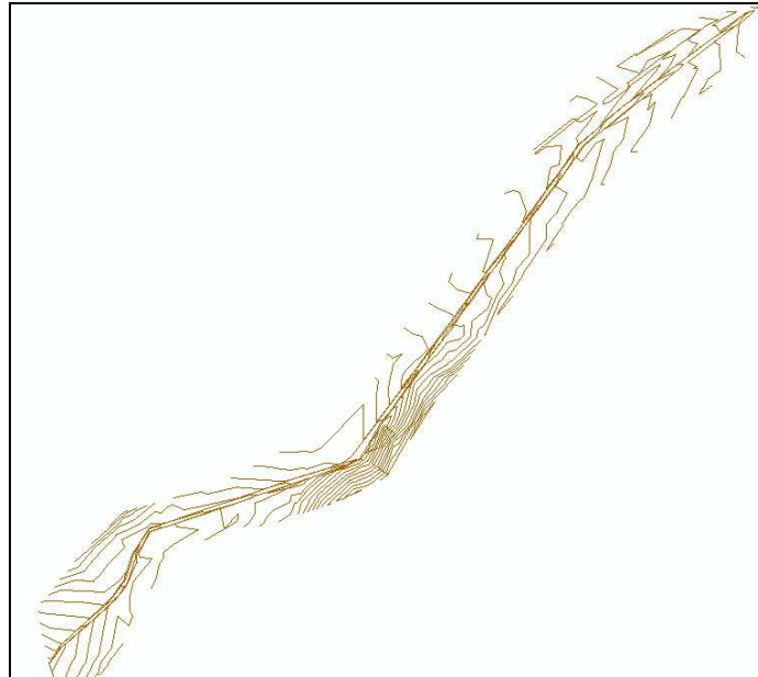
Figura 14. Curvas de nivel obtenidas de datos GPS.
