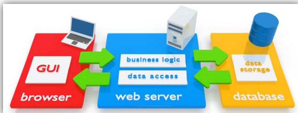
Ilustración 1 – Arquitectura web: cliente-servidor- base de datos
