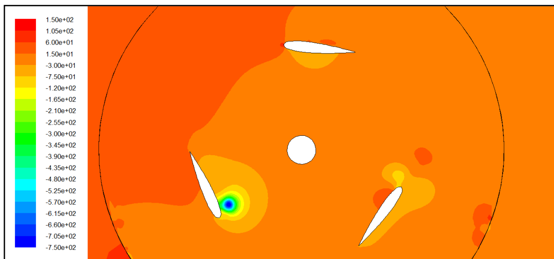
Fig. 4.6: Contornos de presión [Pa] para un NACA 0015, \sigma=1.07 , Pitch=-6^\circ , w=100 rad/s y \epsilon=7.5\% .
