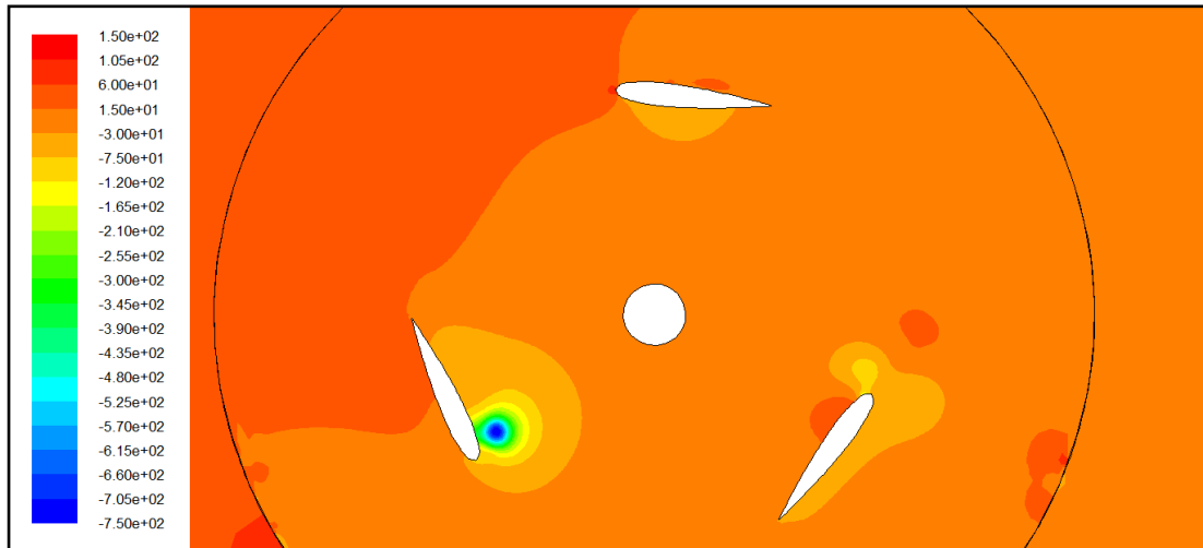
Fig. 4.5: Contornos de presión [Pa] para un NACA 0015, \sigma=1.07 , Pitch=-6^\circ y w=100 rad/s
