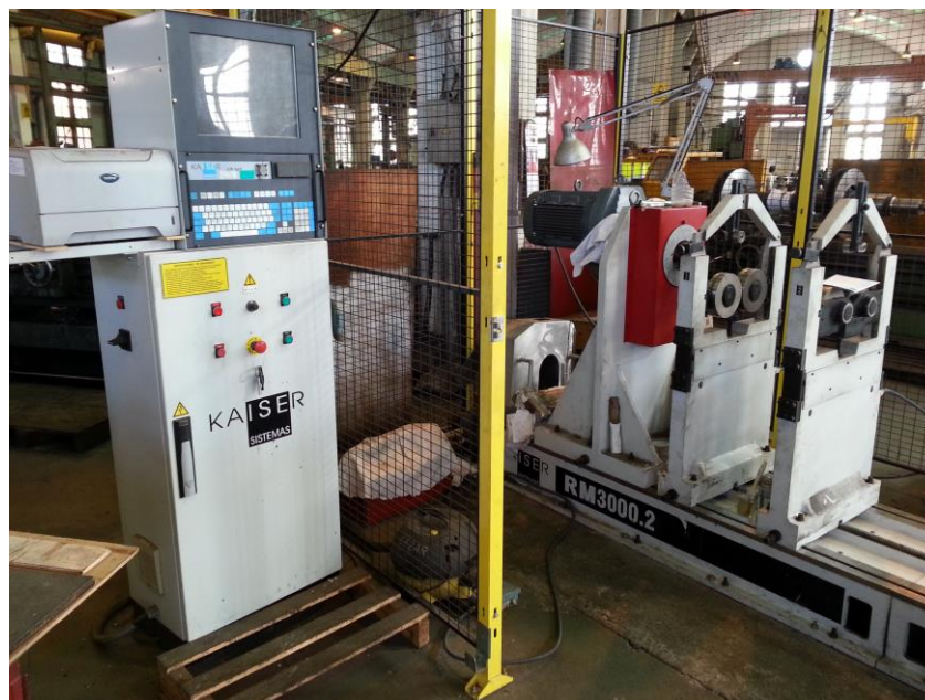
Figura 36. Máquina equilibradora utilizada para la ejecución del test U_{MAR} y U_{RR} .
