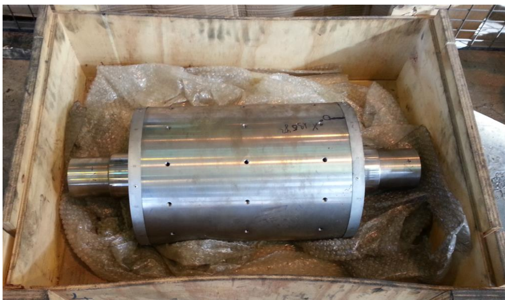
Figura 30. Rotor patrón a tener en perfecto estado de conservación.
