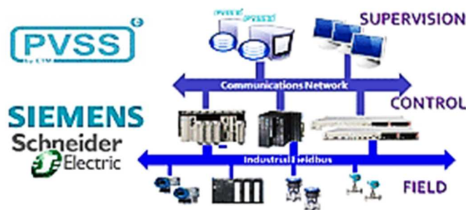
Figura 2 – Estructura de capas de UNICOS
