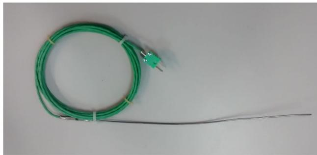
Figura 4.3: Sonda de medición de la temperatura, Pt100.
