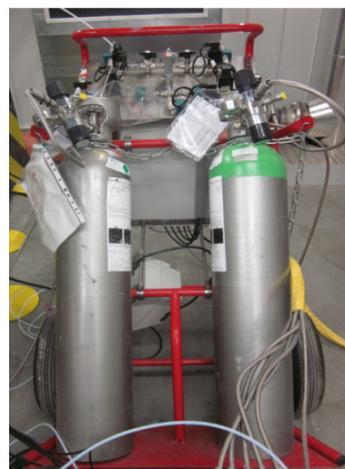
Figura 2.31. Carro envenenamiento con botellas de SO<sub>2</sub> (Izq) y H<sub>2</sub>S (Drcha).
