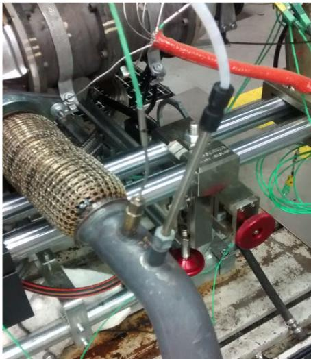
Figura 4.2. Picajes de presión (tubo blanco) y temperatura (cable verde) en la línea de escape.
