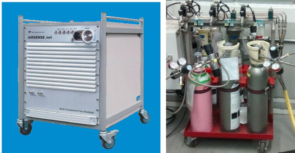
Figura 2.24. Izq: imagen del espectrómetro de masas [2.13]. Drcha:: botellas de gases para la calibración del espectrómetro.
