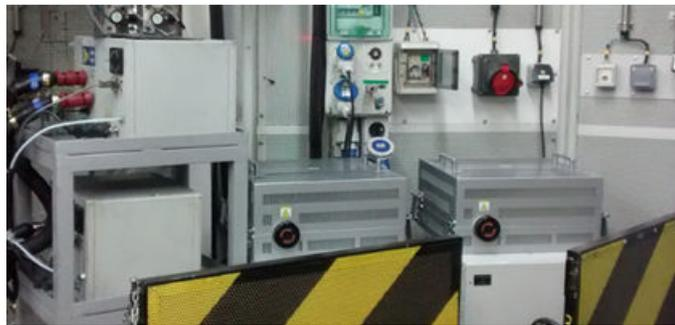
Figura 2.20. Horno analizador de las partículas THC.
