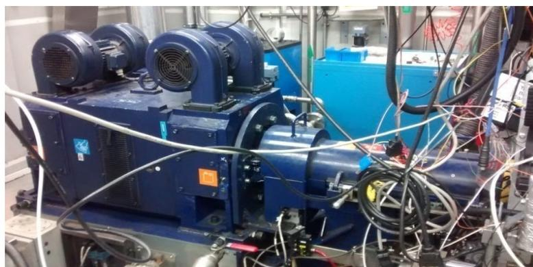
Figura 2.13. Freno dinámico.
