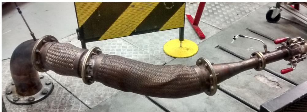
Figura 2.6: Conexión de la línea de escape con presurización mediante un cierre estanco a la línea inferior del ACS.
