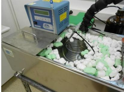
Figura 21. Serpentín metálico y baño calefactor.
