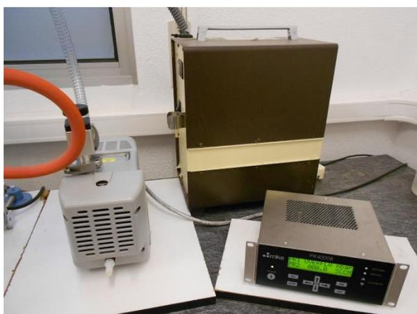
Figura 25. Bomba de vacío (izquierda), indicador de presión (derecha) y criostato (centro).
