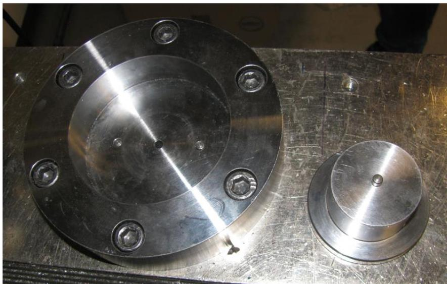
**Figura 9.2** Utillaje para la extracción empleado en el ensayo de push out
