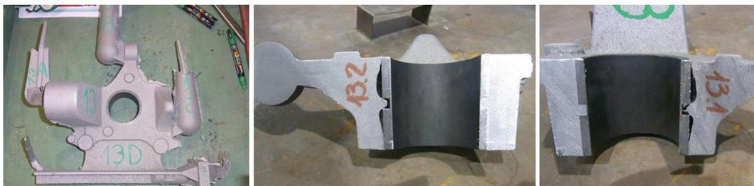
**Figura 8.1** Pieza fundida con inserto. Sección que muestra el defecto.
