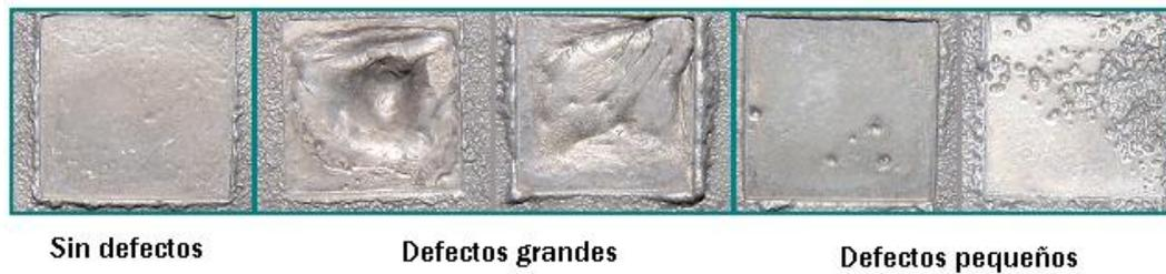
**Figura 6.7** Resultados obtenidos en las superficies de la pieza en contacto con los enfriadores.
