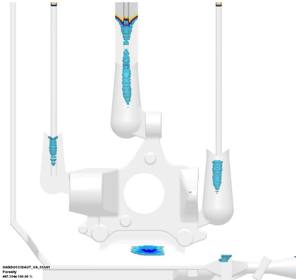
**Figura 7.4.** Resultado de porosidad por contracción. Sólo aparecen defectos de porosidad en las mazatoras y en el ataque a pieza.
