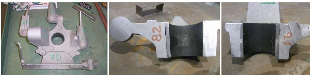
Figura 8.5 Pieza realizada con un inserto con media ranura.
