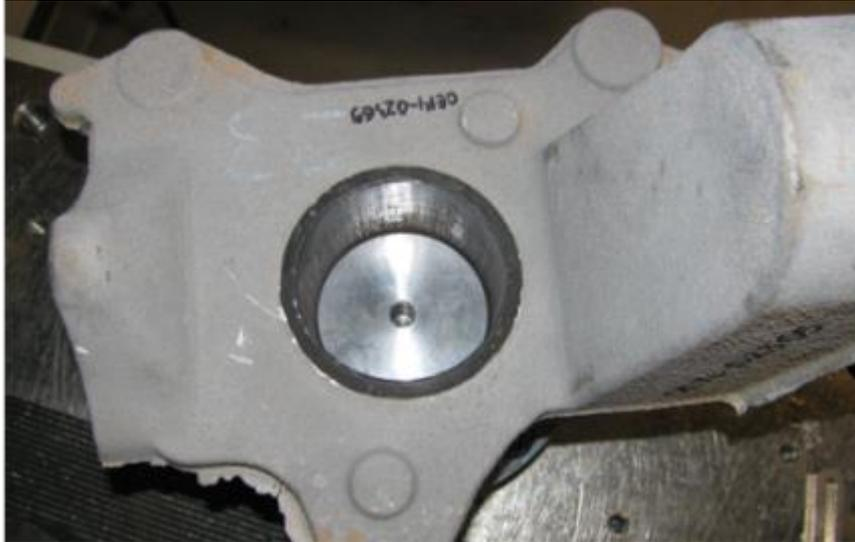
**Figura 9.3** Montaje de la pieza a ensayar sobre el plato de mayor diámetro.
