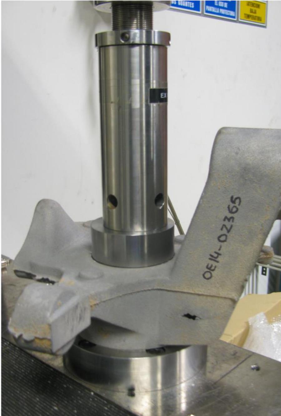
**Figura 9.4** Se puede ver sobre la pieza el elemento mediante el cual se realizará la fuerza normal de extracción.
