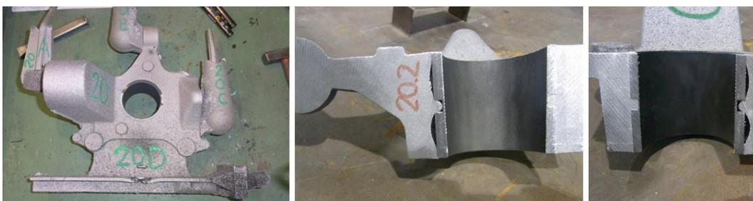
Figura 8.7 Pieza con inserto tratado para su limpieza y con ranura completa.
