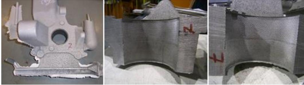
**Figura 8.13** *Imágenes que muestran una de las cuatro piezas sanas obtenidas con el empleo de insertos moleteados.*
