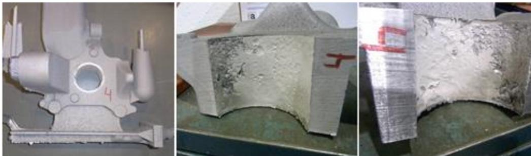
**Figura 8.12** Pieza obtenida mediante la aplicación de pintura sobre el inserto.
