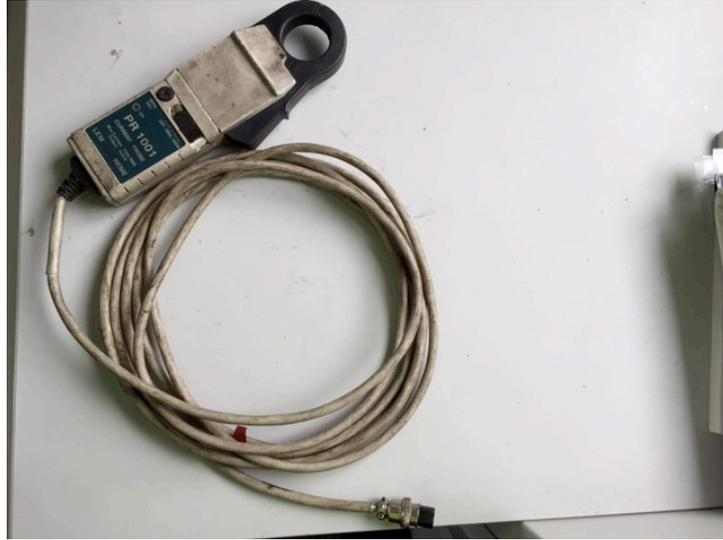
Imagen 2.3.2.7 – Pinza amperimétrica.
