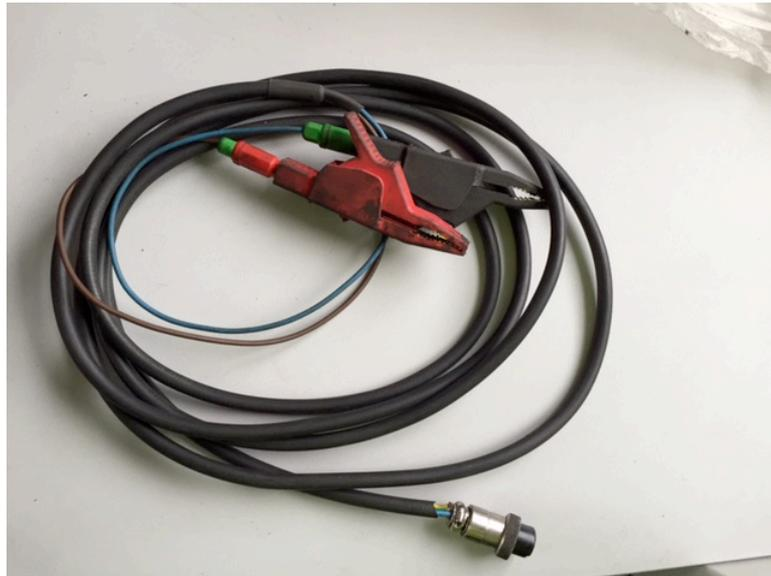
**Imagen 2.3.2.6 – Transductor de tensión.**
