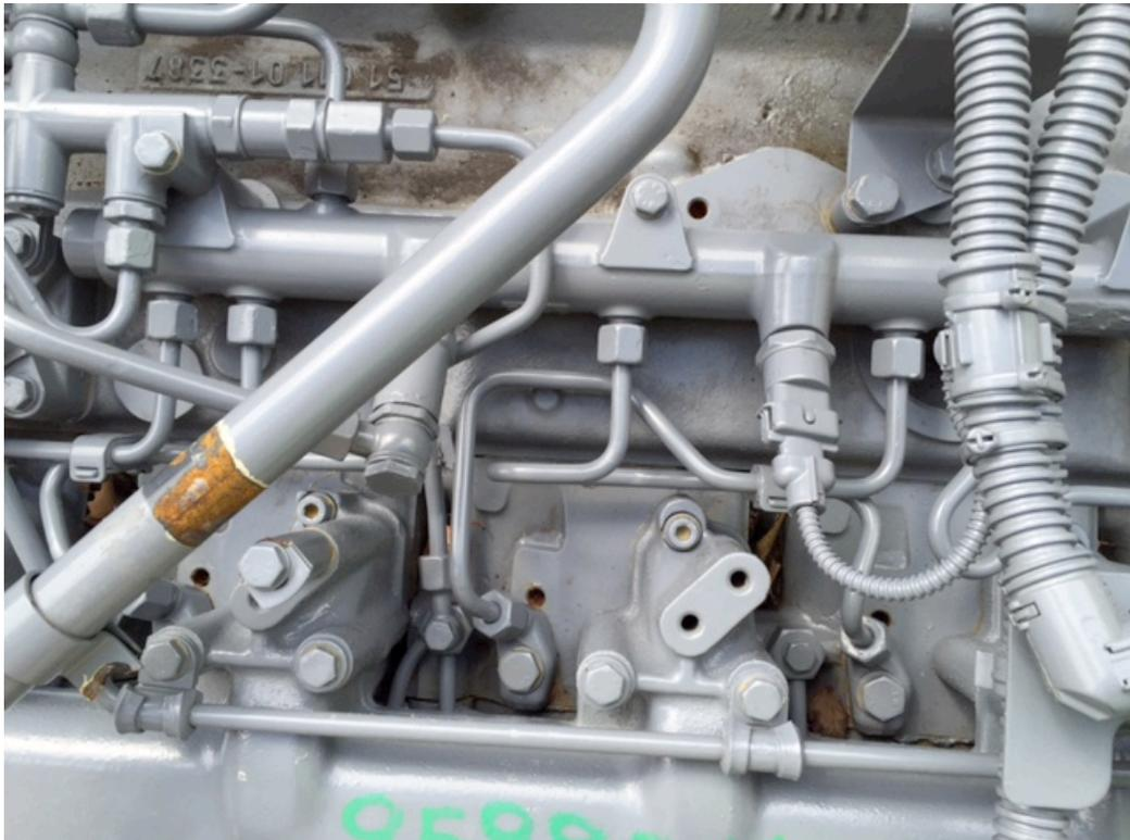
**Imagen 3.3.7 – Tuberías de inyección.**
