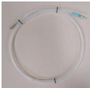
Imagen 2.3.2.8 – Sensor presión cárter.
