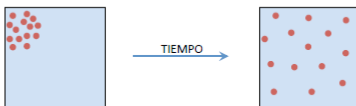
Figura 1. Proceso de difusión. La difusión se define como el proceso mediante el cual se transporta materia de una parte de un sistema a otra debido a movimientos moleculares aleatorios conocidos como movimientos brownianos.
