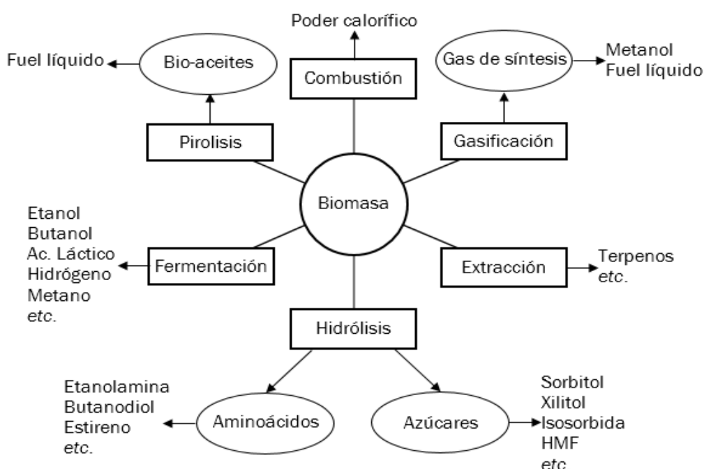
Figura 1. Rutas y productos en los procesos de conversión de la biomasa. Adaptación de Moulijn et al., 2013.
