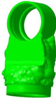
Figura 53 Optimización topológica del porta rótulas simple
