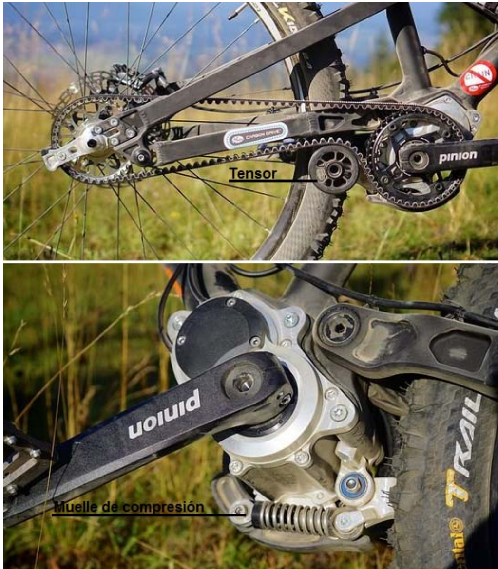
Imagen 4.26: Sistema de transmisión por correa con tensor dinámico incorporado.
