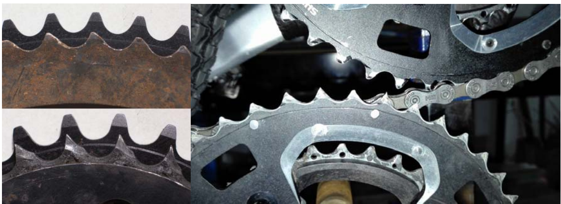
Imagen 4.15: Dos comparativas de plato con dientes desgastados y dientes nuevos. Giro en sentido horario.
