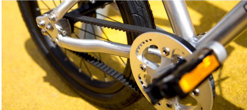
Imagen 4.24: Sistema de transmisión por correa sin tensor.
