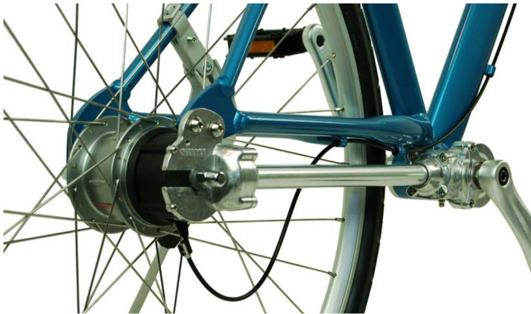
Imagen 4.30: Eje de torsión (sólo transmisión)
