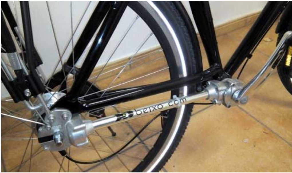
Imagen 4.3: detalle de transmisión por eje de torsión
