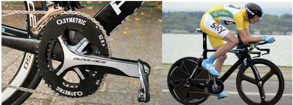
Imagen 3.12: sistema de platos tipo "O-Symetric" usado por C. Froome
