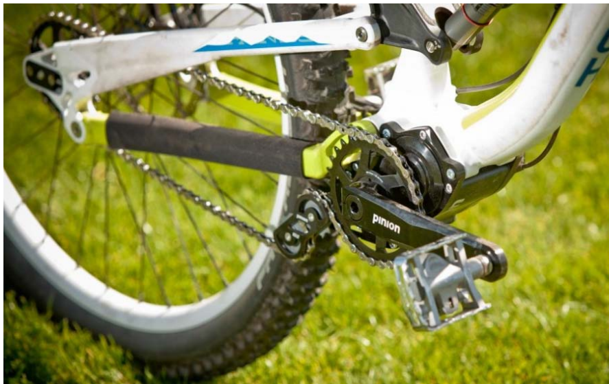
Imagen 4.31: Gearbox central / Desmultiplicación antes de medio transmisor.
