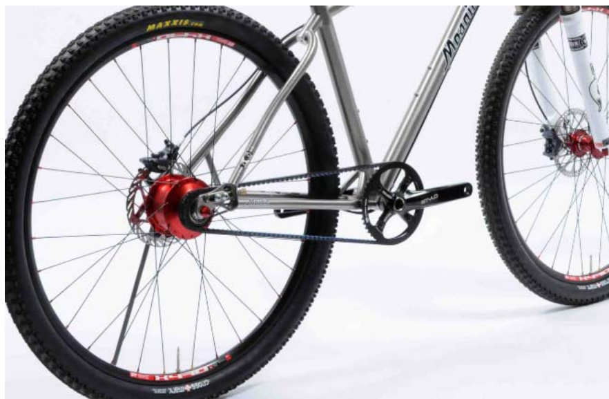
Imagen 4.32: Gearbox en buje / Desmultiplicación después de medio transmisor.
