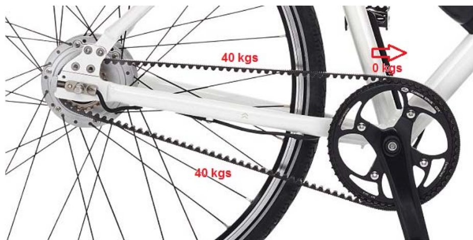
Imagen 4.21: Reparto de precarga en estático.
