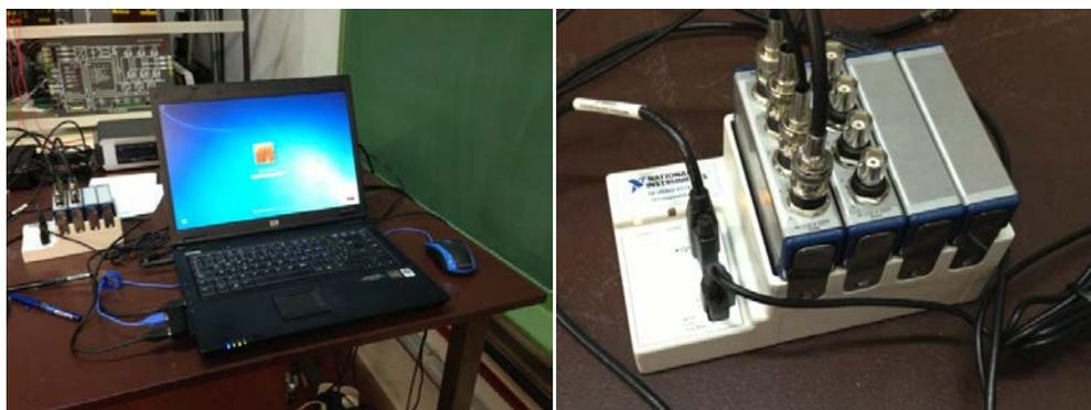
Figura 4.10 Ordenador para la adquisición de datos y su sistema
