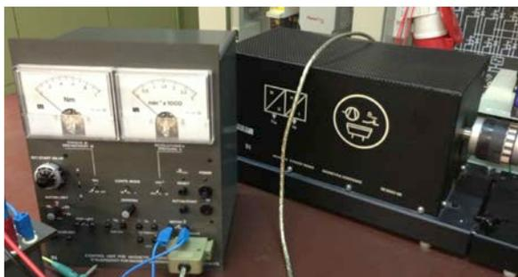
Figura 4.5 Freno de polvo magnético y unidad de control de Lucas-Nulle
