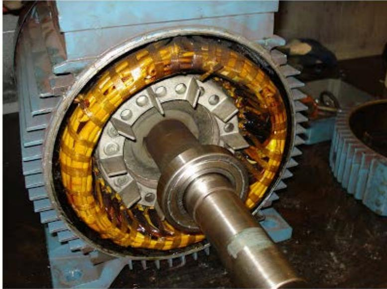
**Figura 2.3** Rotor de motor de jaula de ardilla
