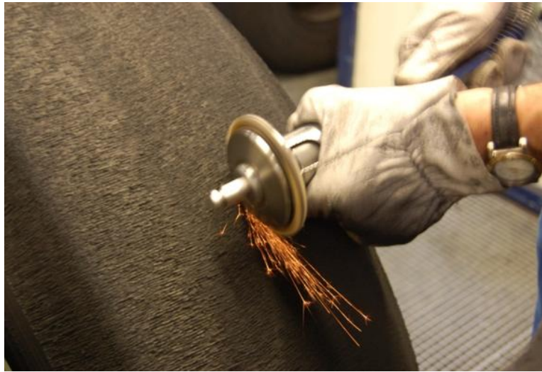
Figura 2.9. Cepillado manual de la cima de una carcasa
