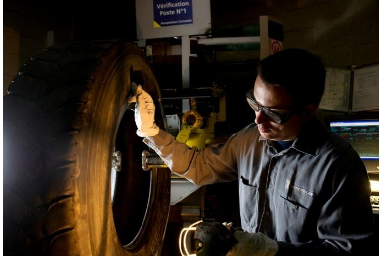
Figura 2.8. Operario verificando una carcasa
