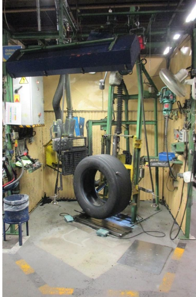
Figura 3.5. Puesto completo de Cepillado Manual
