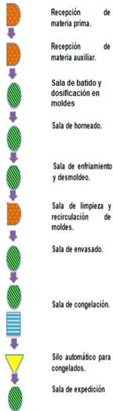
Figura 4. Diagrama de recorrido de los muffins.
