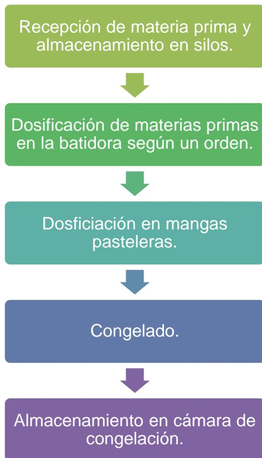
Figura 5. Diagrama de flujo de la producción manual de masas batidas.
