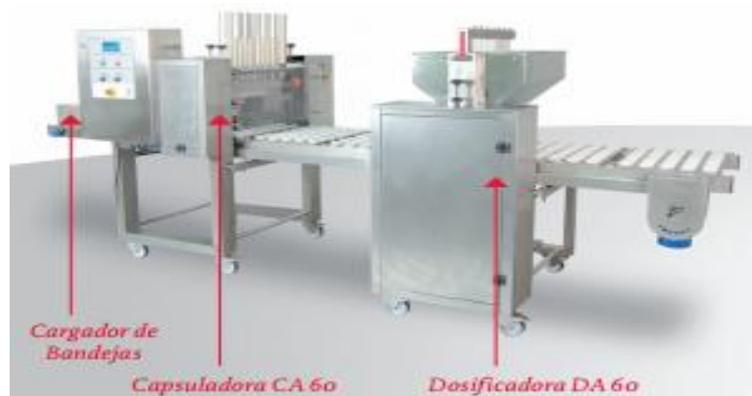
Imagen 6. Máquina cargadora de bandejas, capsuladora y dosificadoras.
