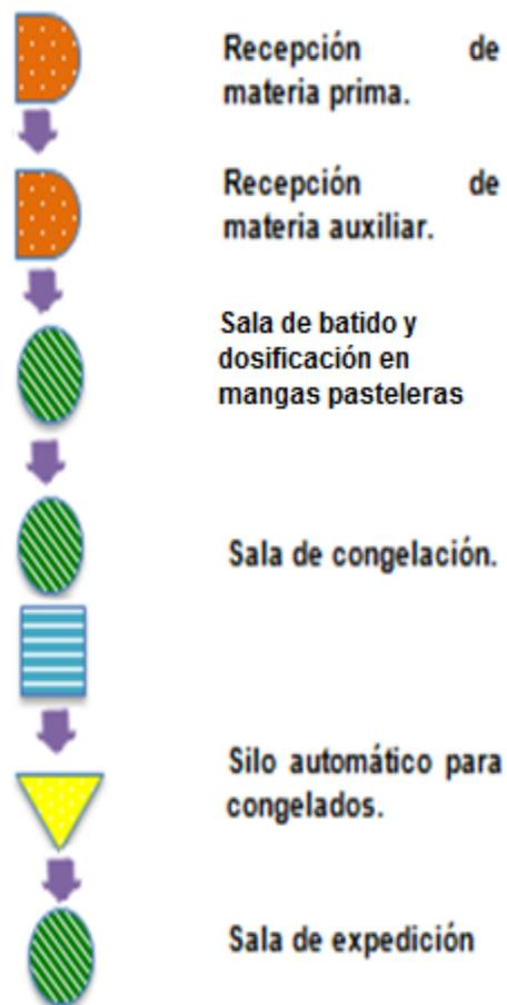
Figura 6. Diagrama de recorrido de la producción manual de masas batidas.
