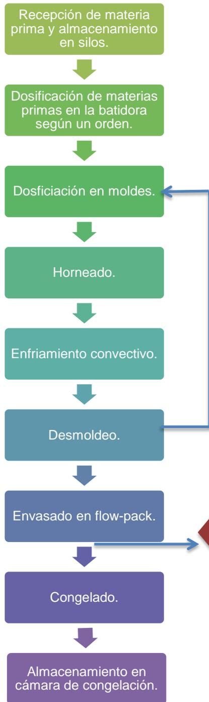
Figura 3. Diagrama de flujo de los muffins.
