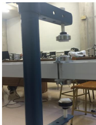
Figura 38: Imanes a atracción por arriba y por debajo de la viga.
