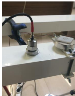
Figura 30: Acelerómetro apoyado en la viga.
