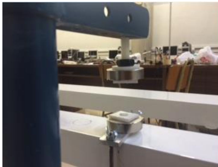
Figura 35: Imanes a repulsión por arriba de la viga.
