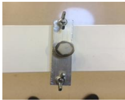
Figura 46: Imán pequeño con soporte colocado en la viga.
