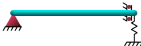
Figura 41: Simetría viga biapoyada
