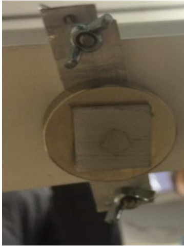
Figura 25: Imán por debajo de la viga.
