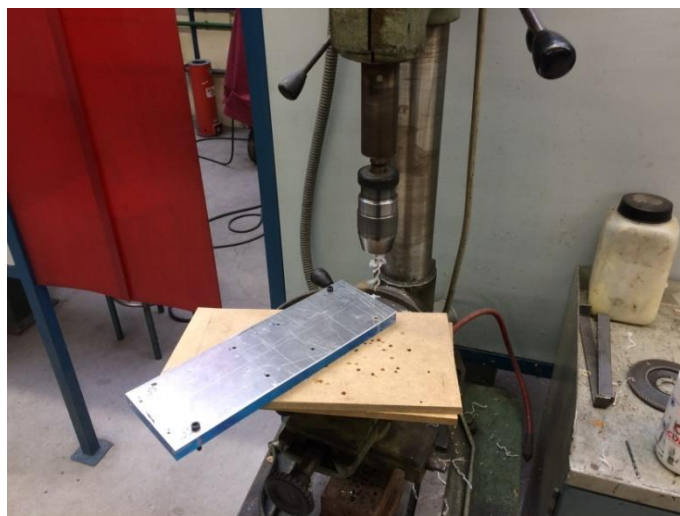
Figura 9. Plantilla Unida a la Placa de Metacrilato
