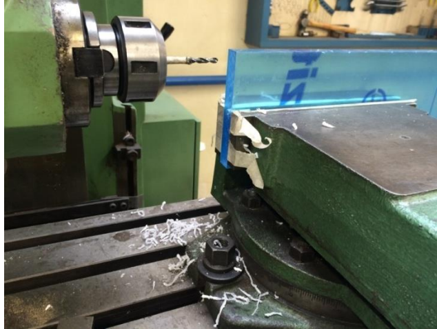
Figura 7. Broca Posicionada para Realizar los Taladros Superiores/Inferiores
