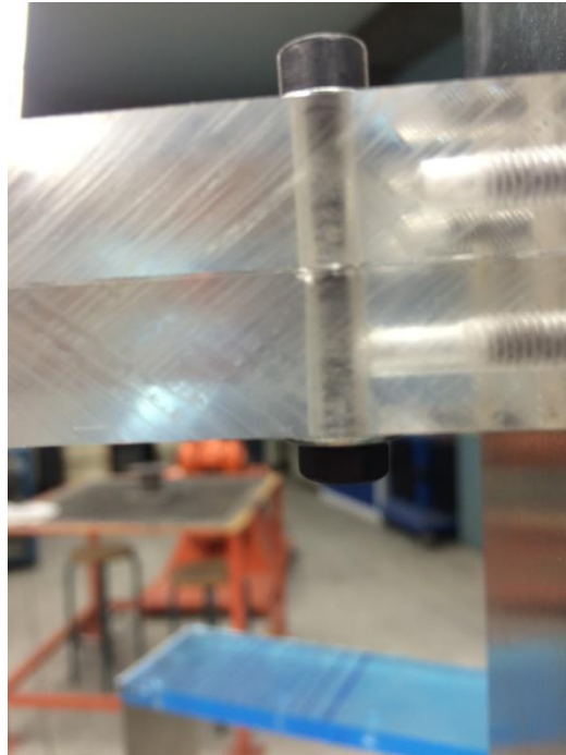
Figura 16. Unión entre Módulos
