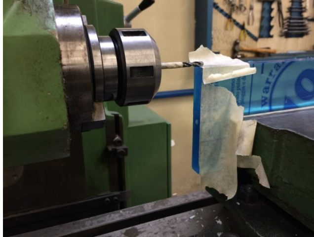
Figura 5. Posicionamiento de la Broca
