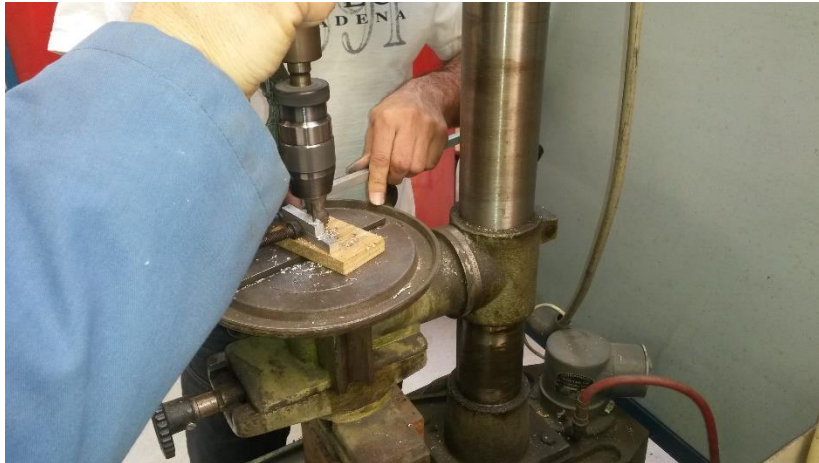
Figura 24. Taladro en la zona lateral del bastidor
