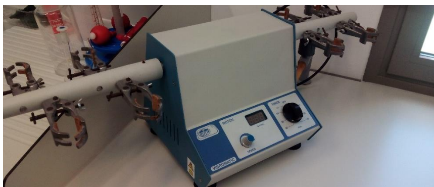
Figura 17.- Vibromatic utilizado en las extracciones.
