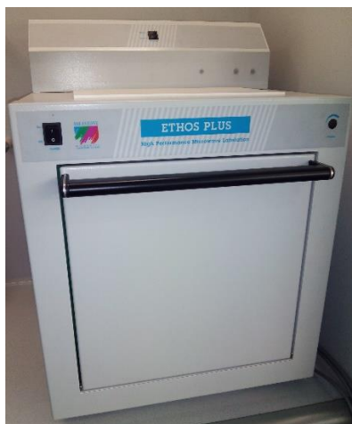
Figura 12.- Horno microondas en el que se hace la digestión.
