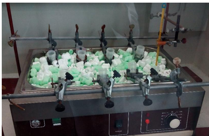
Figura 18. -Baño de agua utilizado para la tercera extracción
