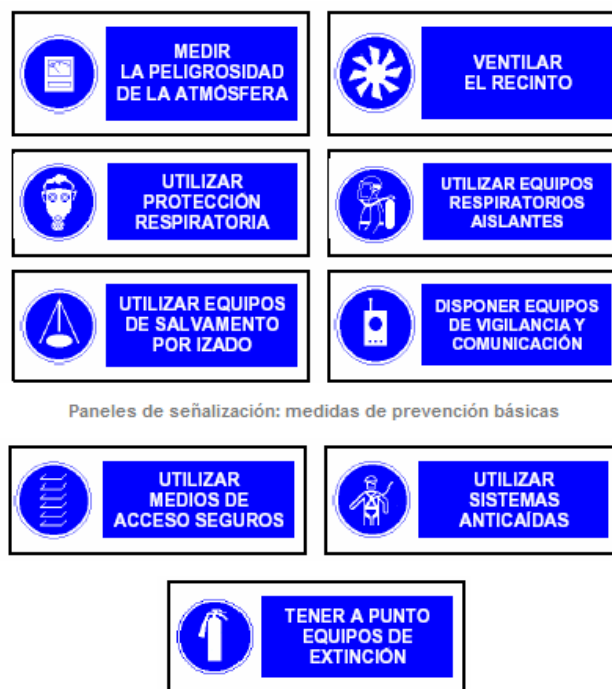
Figura 10: Señalización de obligado cumplimiento
