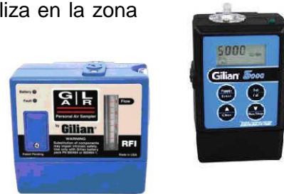
Figura 6: Bombas de bajo y alto caudal
