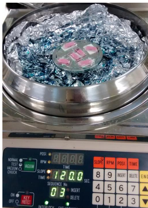
Figura 3.7, ITOs que ya tienen una capa de PEDOT-PSS a los cuales se les ha añadido 200 \mu l de Au NP.
