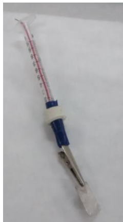
Figura 3. 19, Contraelectro pinzando con la pinza con la cual después se coloca en la celda.
