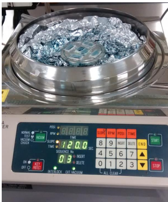
Figura 3.2, ITOs limpios a los cuales se les ha añadido PEDOT-PSS.
