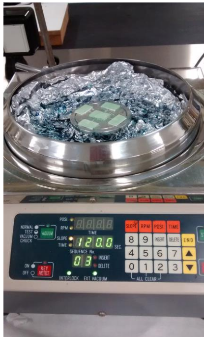
Figura3.5, ITOs colocados en el Spin-Coating con el LuPc 2 antes de que se centrifuguen.
