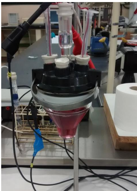
Figura 3.21, Dos tipos diferentes de vinos colocados en la celda. Para ser analizado con los biosensores.
