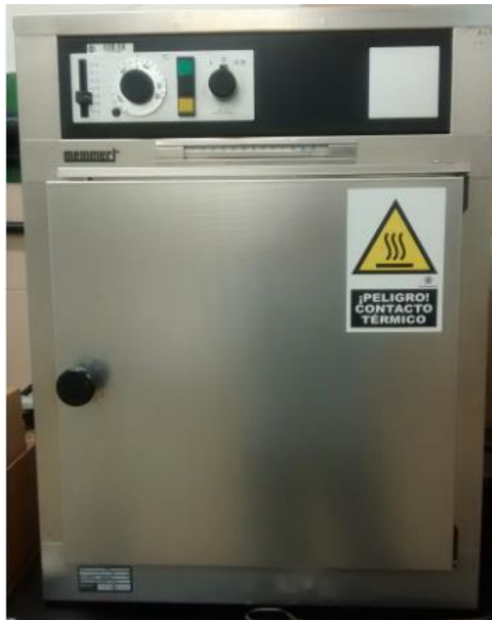
Figura 3.3, Horno en el cual se realiza el curado de los ITOS A 150°C.
