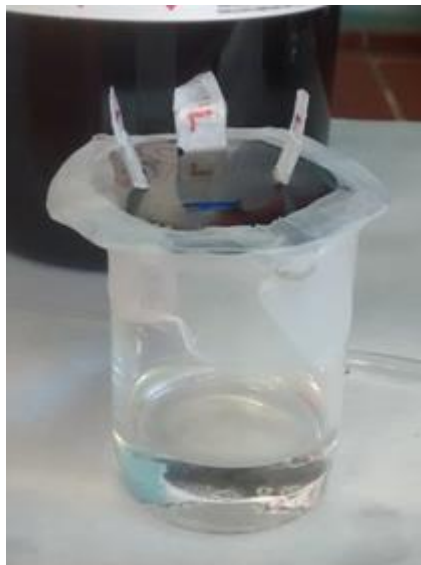
Figura 3.13, Biosensores de Lacasa colocados a los vapores del Glutaraldehído.
