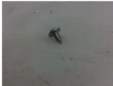
Imagen 50: Tornillo 5x10mm con cabeza dentada
