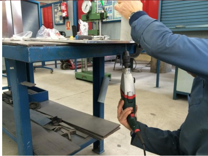
Figura 20. Taladrado del Conjunto Base Soporte
