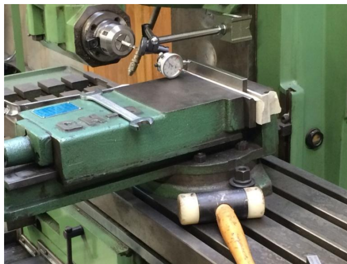
Figura 6. Alineación del Cabezal de la Fresadora
