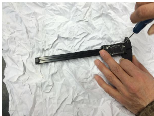
Figura 40. Desmontaje del Calibre
