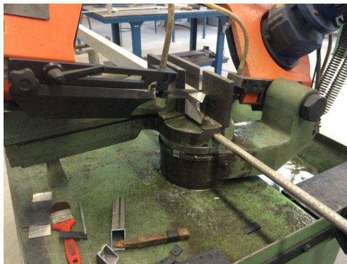
Figura 15. Corte del Perfil de Aluminio con la Sierra de Cinta
