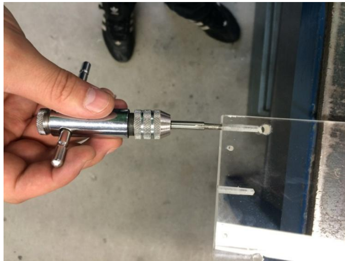
Figura 10. Roscado con Macho de Roscar
