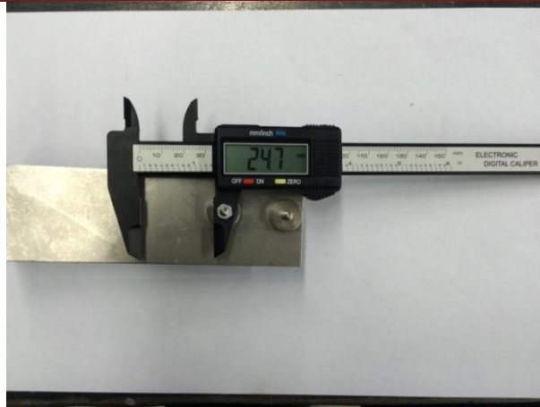
Figura 43. Unión del Calibre a la Pletina Mediante un Imán
