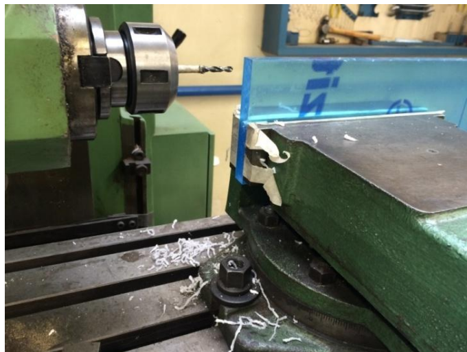
Figura 9. Broca Posicionada para Realizar los Taladros Superiores/Inferiores
