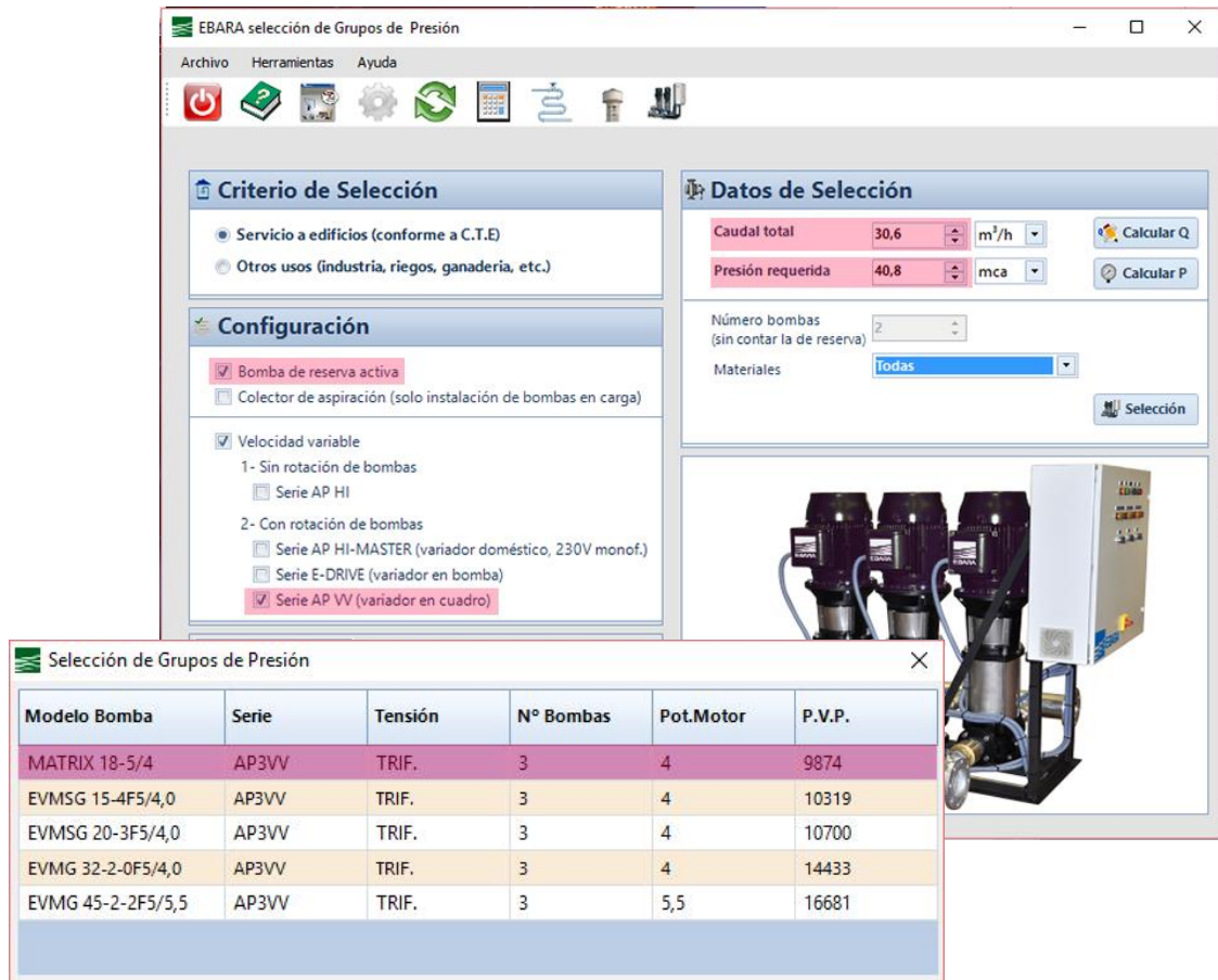
Figura 4.5.6 Selección del grupo de presión con el software “EBARA GPR_Cálculo de grupos de presión”
