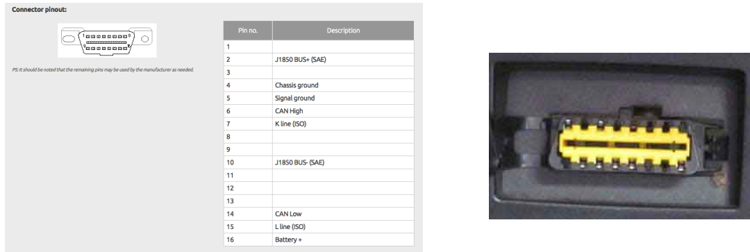
Figura 27. Conexiones eléctricas toma OBD
