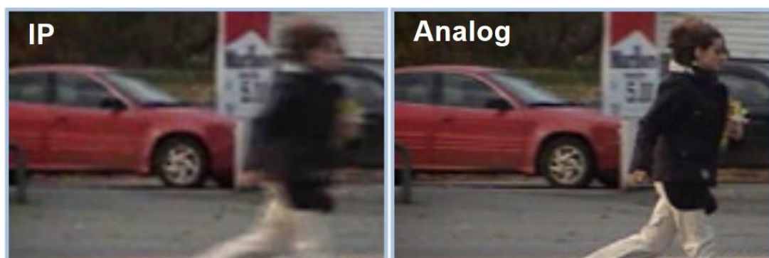
Figura 2. Calidad del vídeo en una cámara IP (izquierda) y una analógica (derecha) [16].
