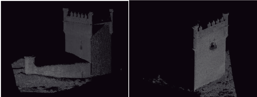
Vistas de las tomas en nube de puntos generadas con Leica.
