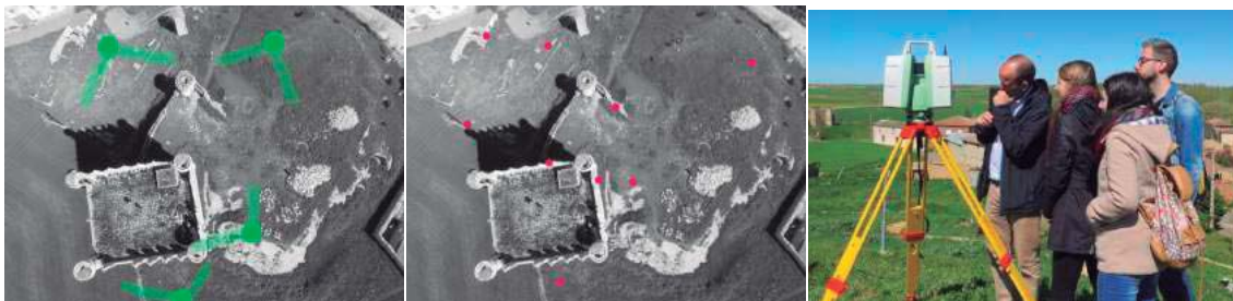
Imágenes en las que se marcan las posiciones del escáner Leica para las tomas, las posiciones de las dianas en el entorno, y fotografías del proceso.
