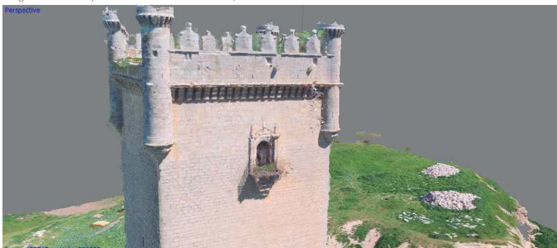
Imagen durante el proceso de levantamiento 3D, la malla con textura real.
