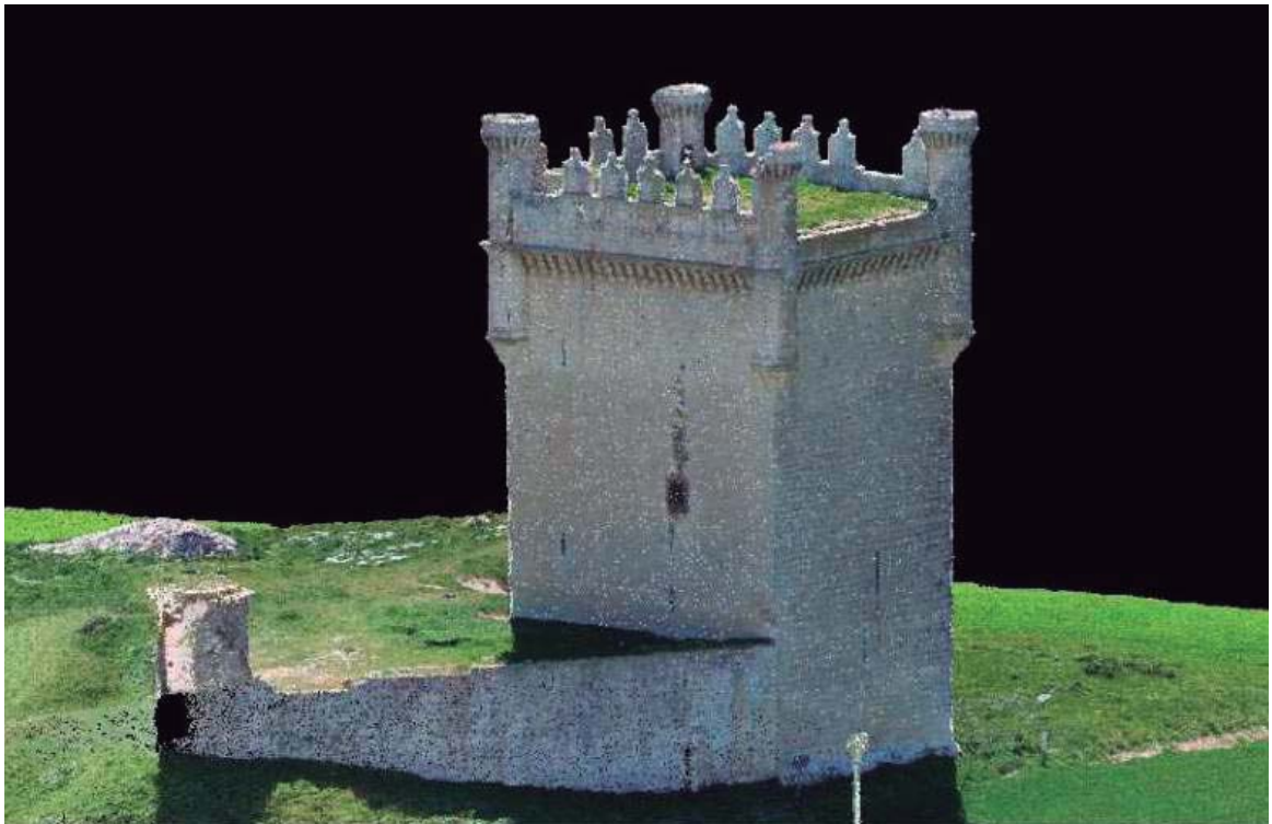
Imagen resultado del proceso de unir las dos nubes de puntos, observamos el color.
