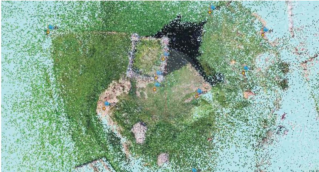
Imagen del proceso de generación de la nube de puntos mediante Agisoft Photoscan.
