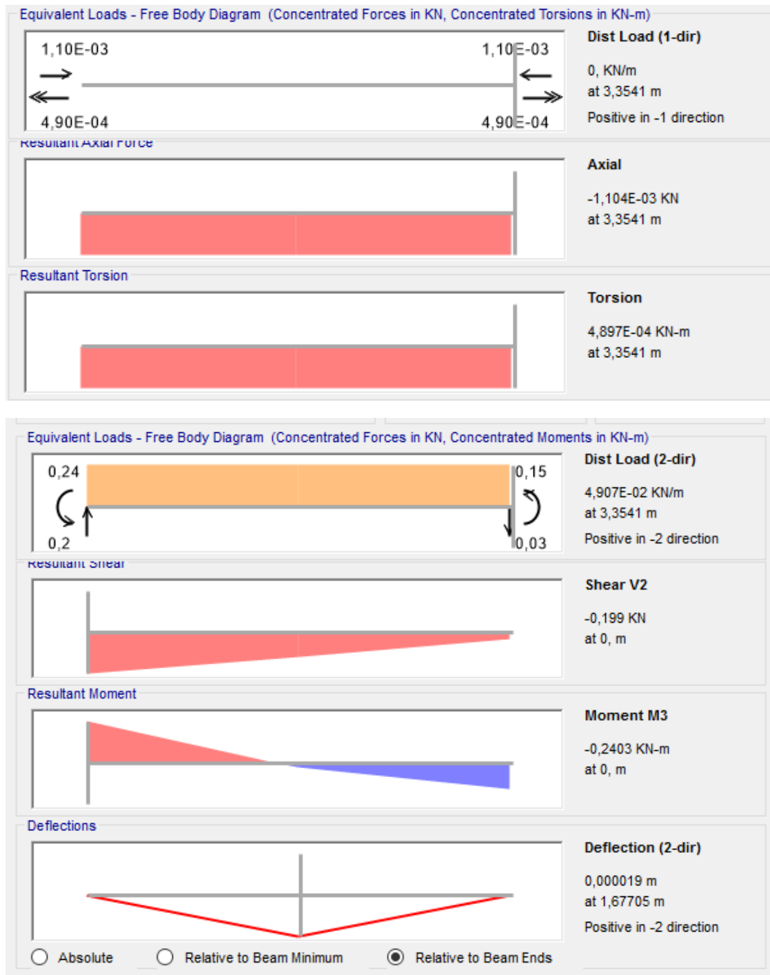
Ilustración 8.29 - Diagramas axial, torsión, cortante, flector flecha, barra más solicitada. SAP2000
