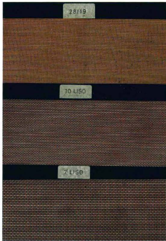
Muestra de los tres tipos de telas para el cilindro formador y muestra de una soldadura eléctrica hilo a hilo
