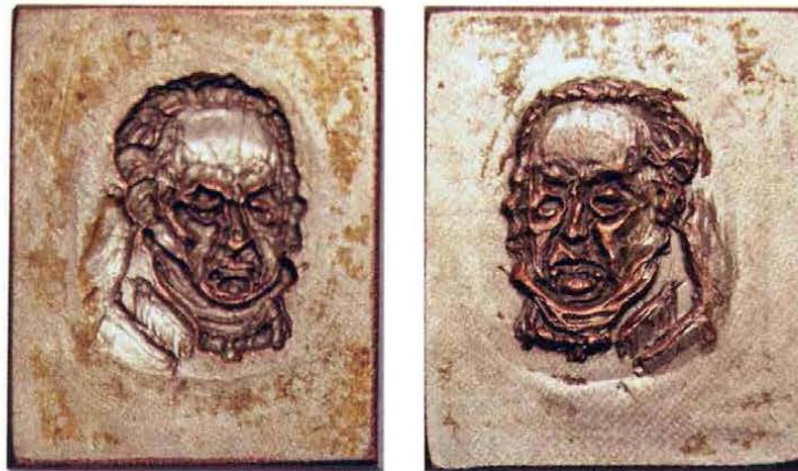
Troqueles para marca de agua de billetes españoles con el motivo del busto de Goya
