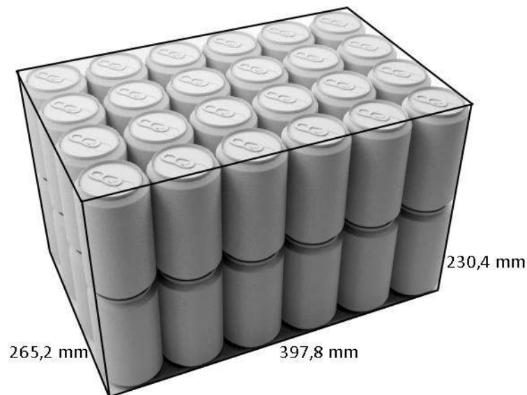
Img.3.58. Medidas de dos packs de 24 latas apilados
