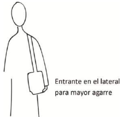
Img.3.102. Nevera con un entrante en las paredes laterales para facilitar el agarre
