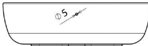
Img.3.183.Diámetro del taladro donde va situado el eje del asa
