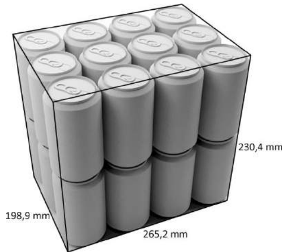
Img.3.54.Medidas de dos packs de 12 latas apilados
