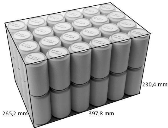
Img.3.58.Medidas de dos packs de 24 latas apilados
