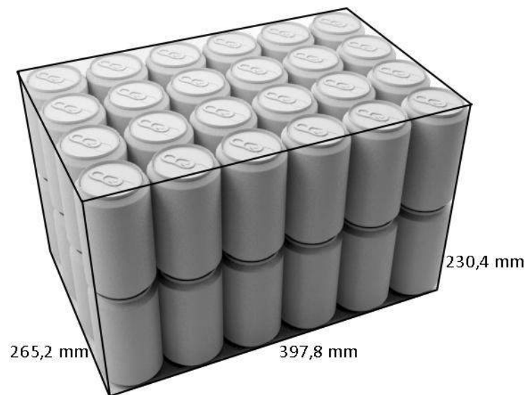
Img.3.58.Medidas de dos packs de 24 latas apilados
