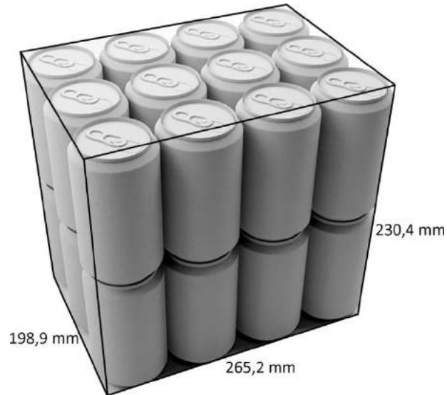
Img.3.54. Medidas de dos packs de 12 latas apilados
