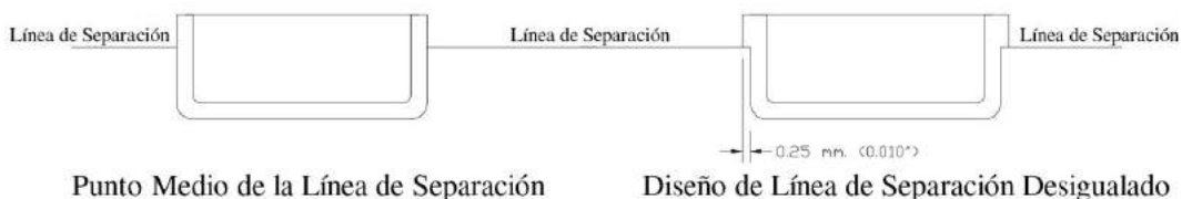
Img.3.77. Línea de separación colocada en una pared lateral
