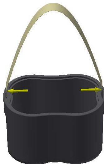
Img.3.236.Fuerzas aplicadas sobre el cinturón
