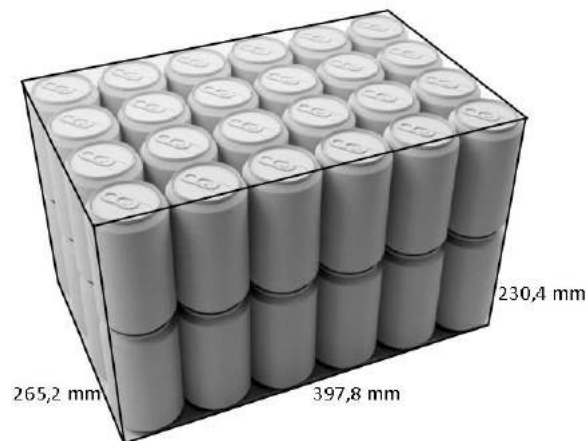
Img.3.58.Medidas de dos packs de 24 latas apilados
