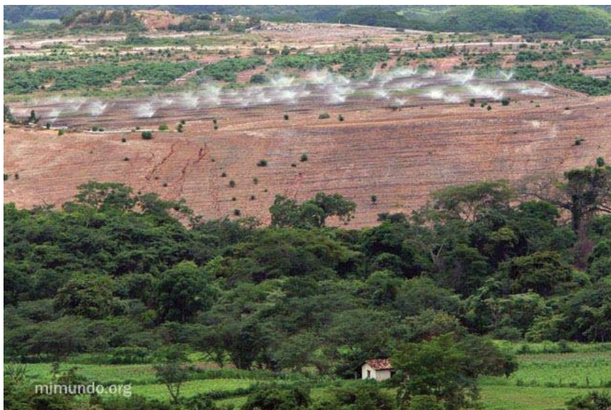
Figura 4. Proceso de lixiviación con cianuro, mina de San Martín (Honduras)
