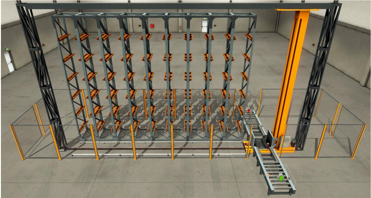
Figura 7.98. Vista frontal estación de gestión de stock
