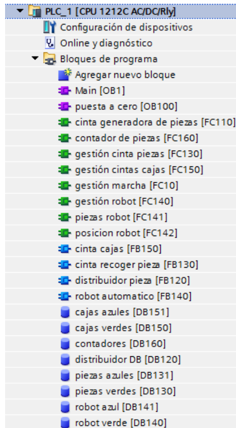
Figura 7.68. Distribución general de bloques. Estación distribuidora
