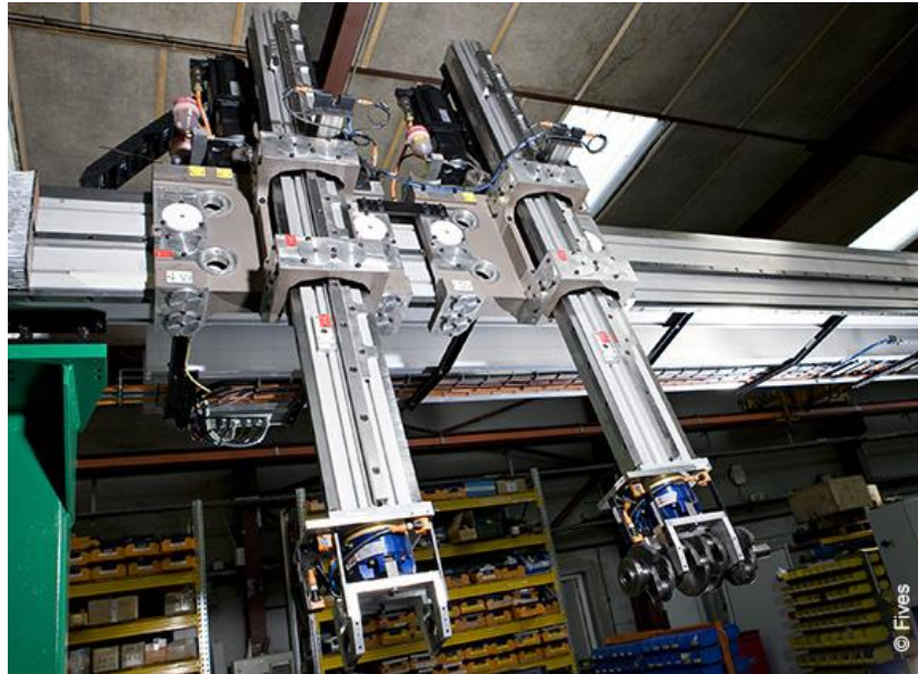
Ilustración 1.11 Foto obtenida de la página web del pórtico del proveedor Cinetic con un carro y doble brazo. Fuente: http://www.fivesgroup.com/
