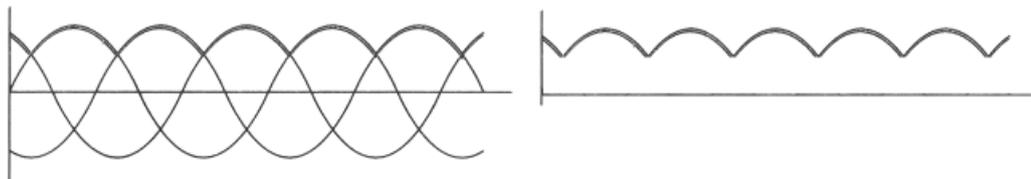
Figura 10. Señal de entrada vs señal rectificada
