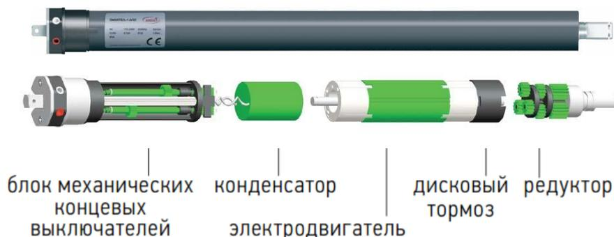
Fig. 19 Despiece del motor tubular para cerramientos. (Amigo®)
