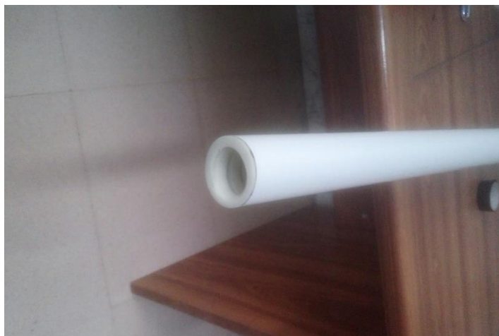
Figura 17. Unión tubo-casquillo inferior
