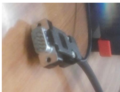
Figura 30. Detalle conector D-SUB
