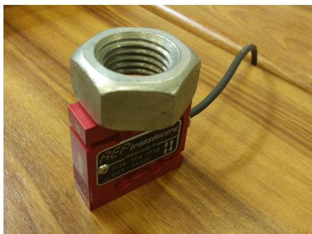
Ilustración 32. Calibración estática de célula de carga
