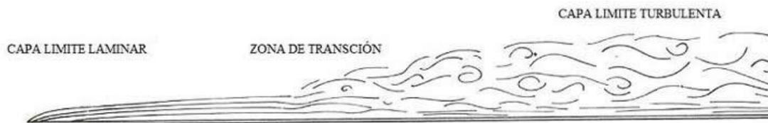
Fig 38. Transición de capa límite laminar a turbulenta. [5]
