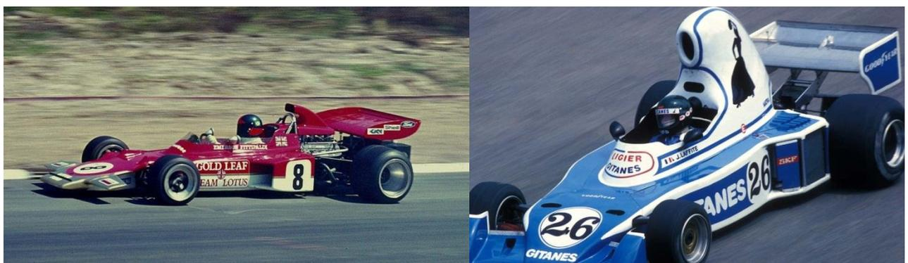
Fig 12. Elementos de refrigeración en la parte anterior y en los laterales (izq.) y toma de aire detrás del piloto (drch.). [GP Library]
