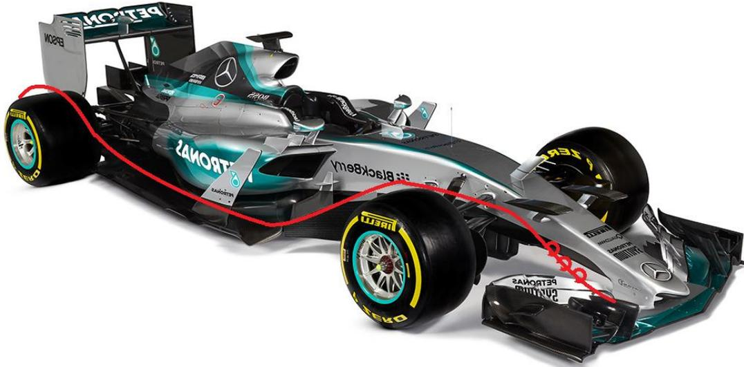
Fig 74. Línea de recorrido del vórtice Y250. [Elaboración propia]
