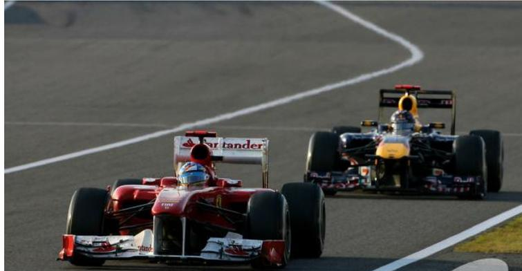
Fig 27. Red Bull atacando con el alerón trasero abierto y Ferrari con el alerón en posición neutra. [GP Library]
