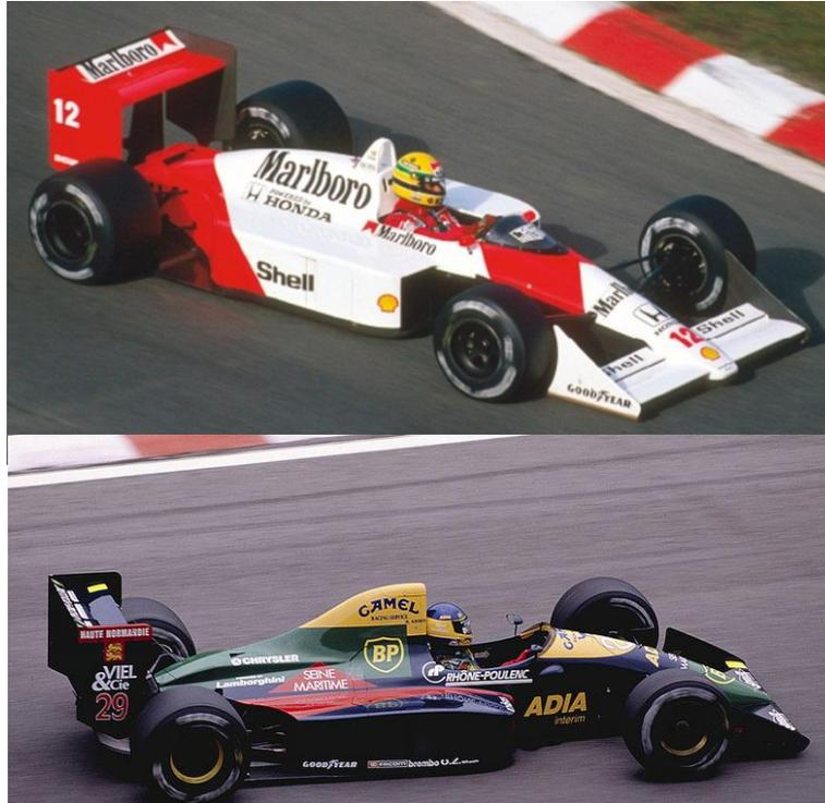
Fig 18. McLaren MP4/4 (arriba) y Fórmula 1 con la toma de aire detrás del cockpit (abajo). [GP Library]
