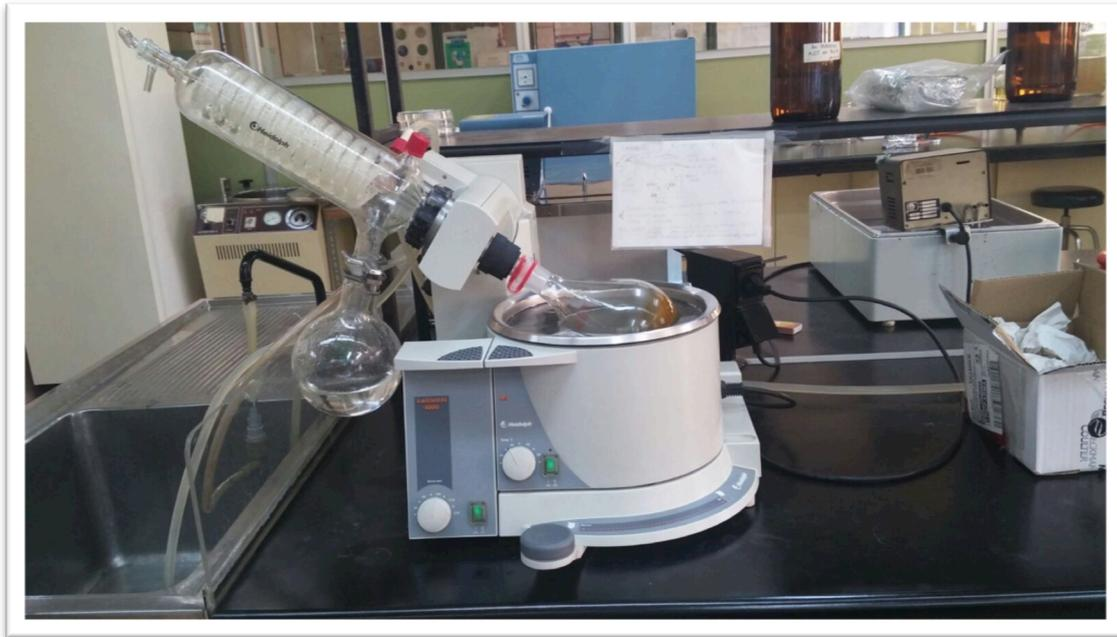
Figura 9: Rotavapor empleado para la obtención de el medio de cultivo y el sobrenadante concentrado
