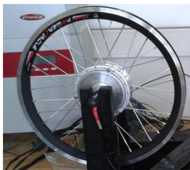
Ilustración 26: Motores BLDC en los cubos de las ruedas.
