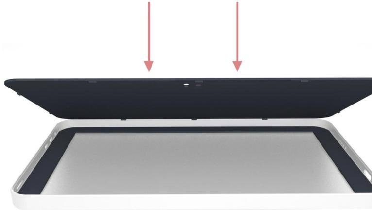
Fig 106. Encaje de la carcasa inferior en la carcasa lateral
