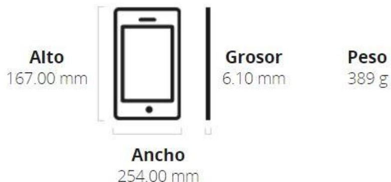
Fig 12. Dimensiones de Sony Xperia Z4 Tablet
