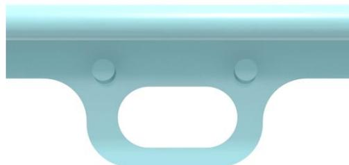
Fig 58. Detalle del hueco para la cámara de la funda
