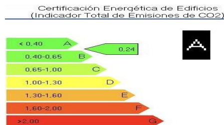
Figura 4: Etiqueta de calificación energética del edificio
