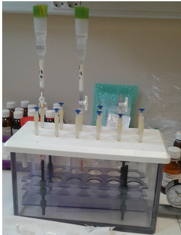
Figura 21: Columnas de resinas de cambio iónico.
