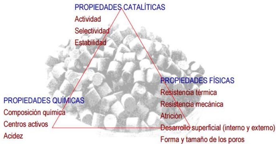
Figura 6. Propiedades a tener en cuenta para la elección o diseño de un catalizador.
