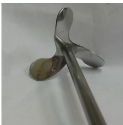
Figura 4.5. Agitador tipo hélice marina usado en los ensayos de HE y fermentación.
