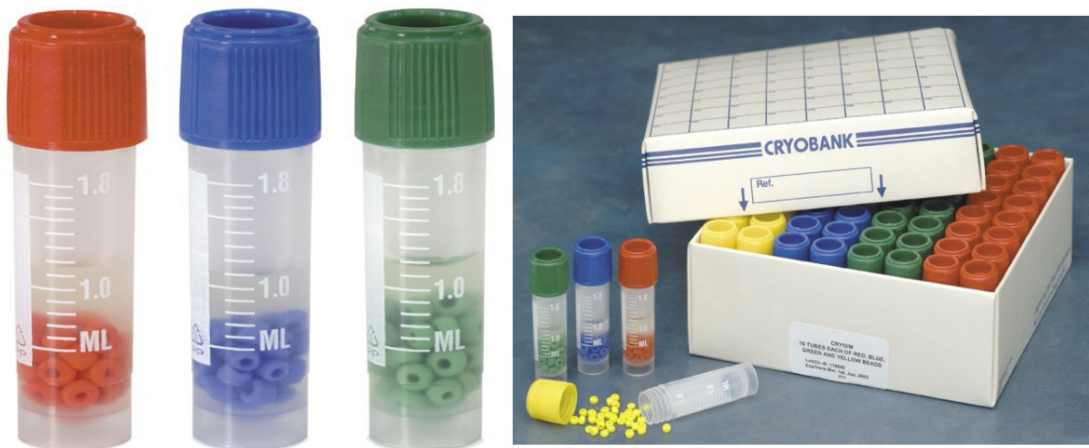
Figura 28. Crioviales empleados en la congelación y conservación de las cepas de Legionella
