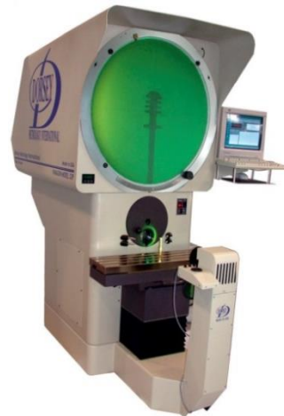
Figura 2.3. Sistema óptico de medida por luz proyectada de eje horizontal.
