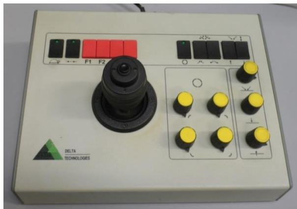
Figura 5.5. Consola para el control de la iluminación y los movimientos de la mesa
