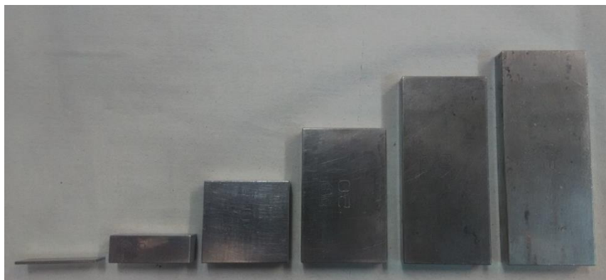
Figura 5.8. Bloques patrón utilizados (de 1,0005 a 80 mm)
