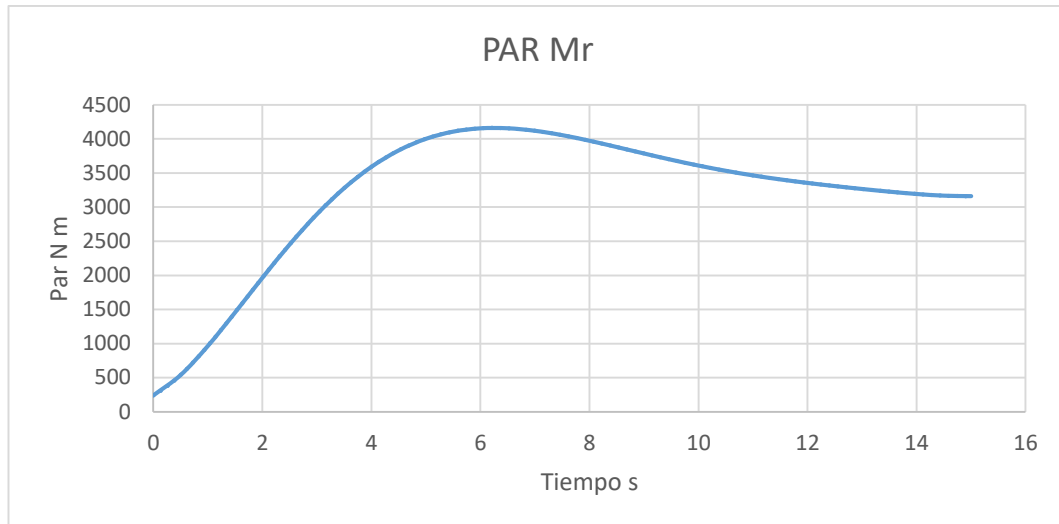
Gráfica 3.4 Curva de par en eje posible ensayo 1
