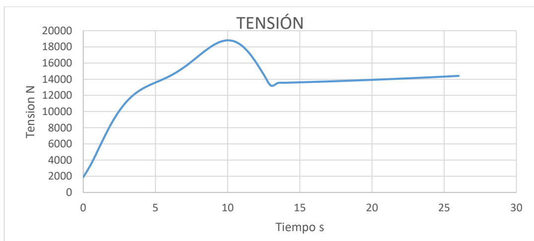
Gráfica 3.9 Curva de tensión posible ensayo TB51
