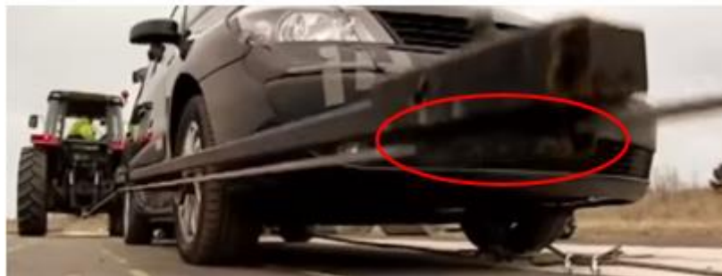
Imagen 4.18 Tensión de cable de guiado y orificio de paso
