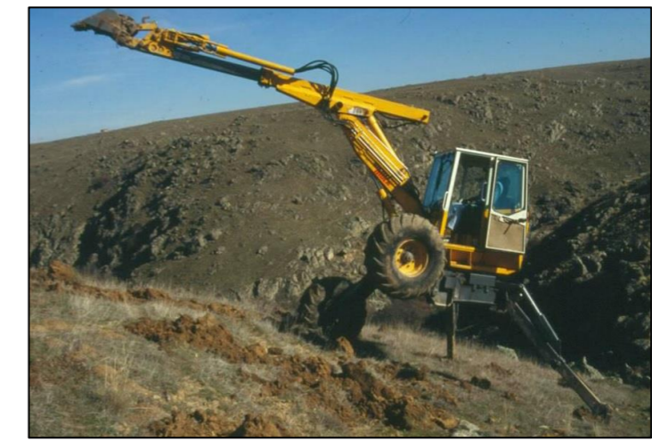
Retroaraña 98/120 kW (131/160 CV) Cabezal de desbrozadora de cadenas y ahoyadora con cazo de 40 cm
